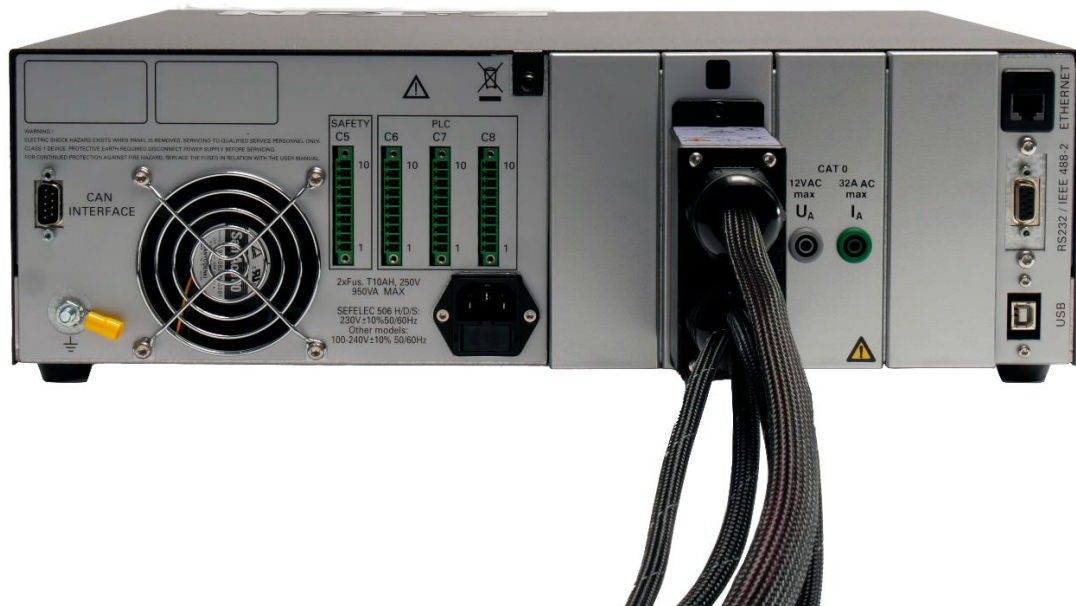
Vue arrière d'un appareil de la série 5x équipé de l'option SEFM-xx : scanner interne
