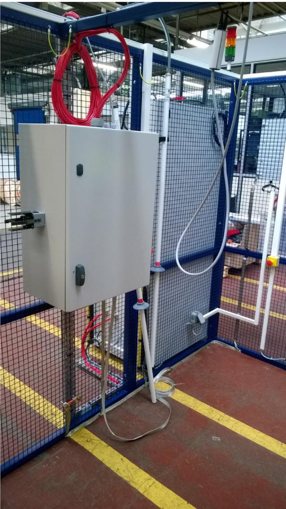
Interface de raccordement et perche de sécurité
