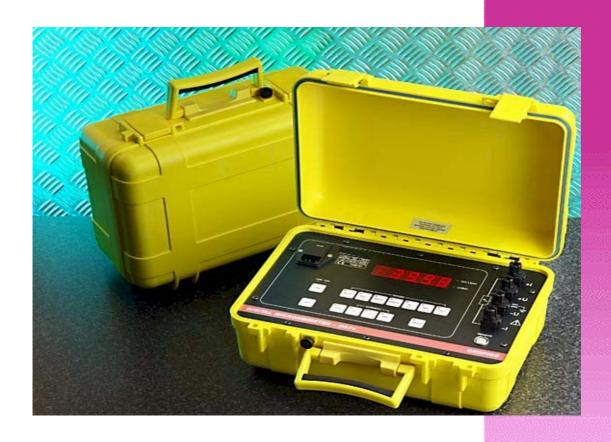
Le MO7 est un microhmmètre numérique robuste et portable destiné à la mesure de résistances de faible valeur. Utilisant une batterie acide plomb hermétique avec chargeur incorporé, le MO7 est capable de mesurer avec un courant de 10 A sur la gamme la plus faible.
